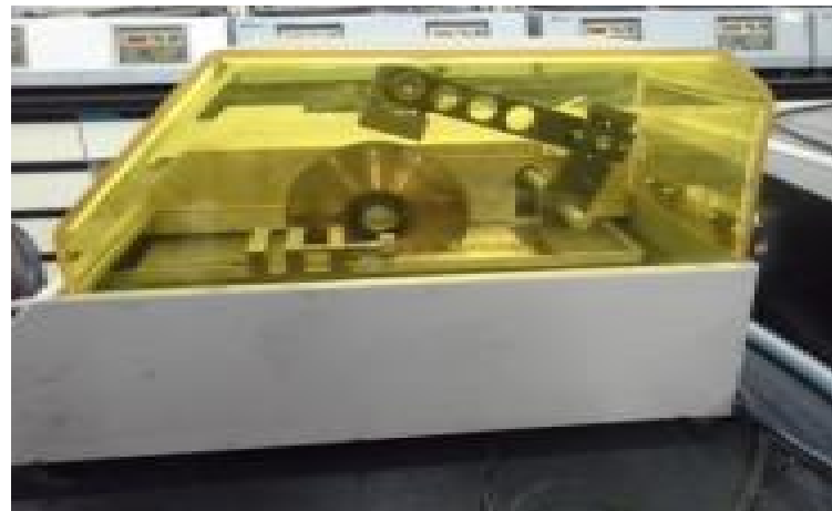
위험기계기구 방호장치(안전덮개) 설치 : 등근톱, 전동드릴 등
