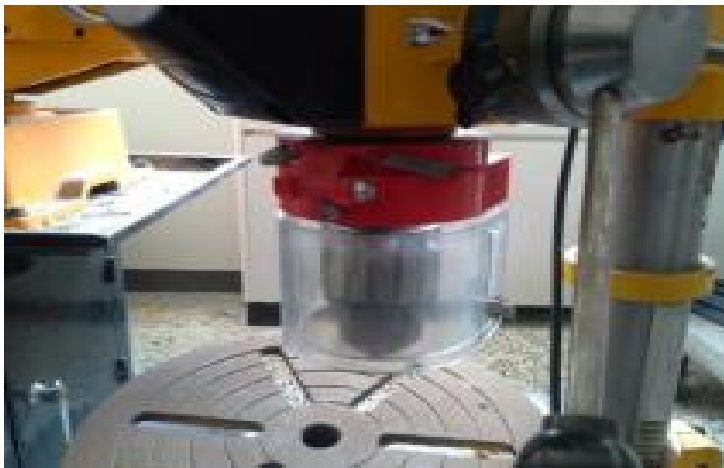
위험기계기구 방호장치(안전덮개) 설치 : 등근톱, 전동드릴 등
